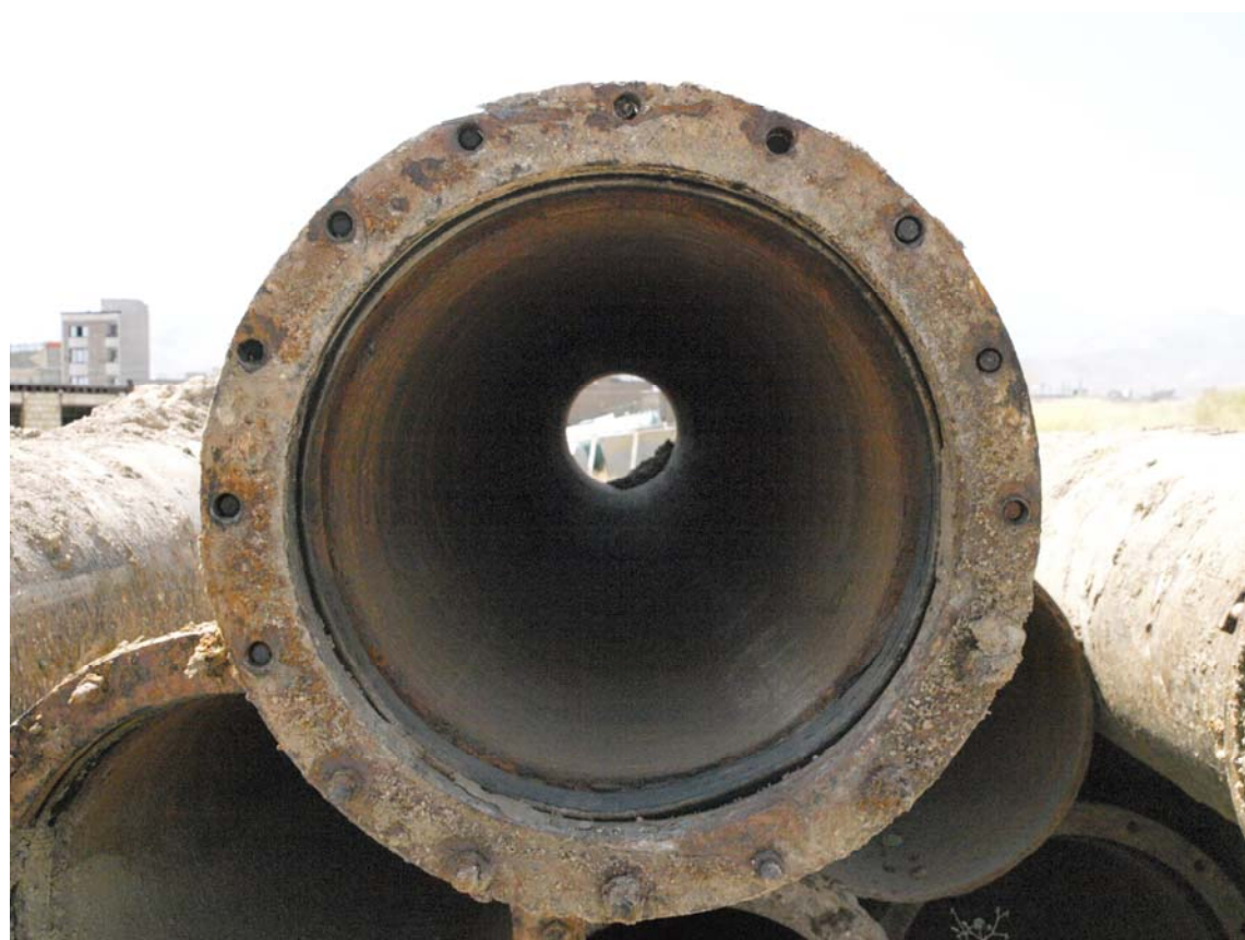
تصویر ۳-لوله چدنی نشکن بولتد گلندی سایز ۵۰۰ میلی متر، تولید سال ۱۳۵۴ شرکت لوله و ماشین سازی ایران
