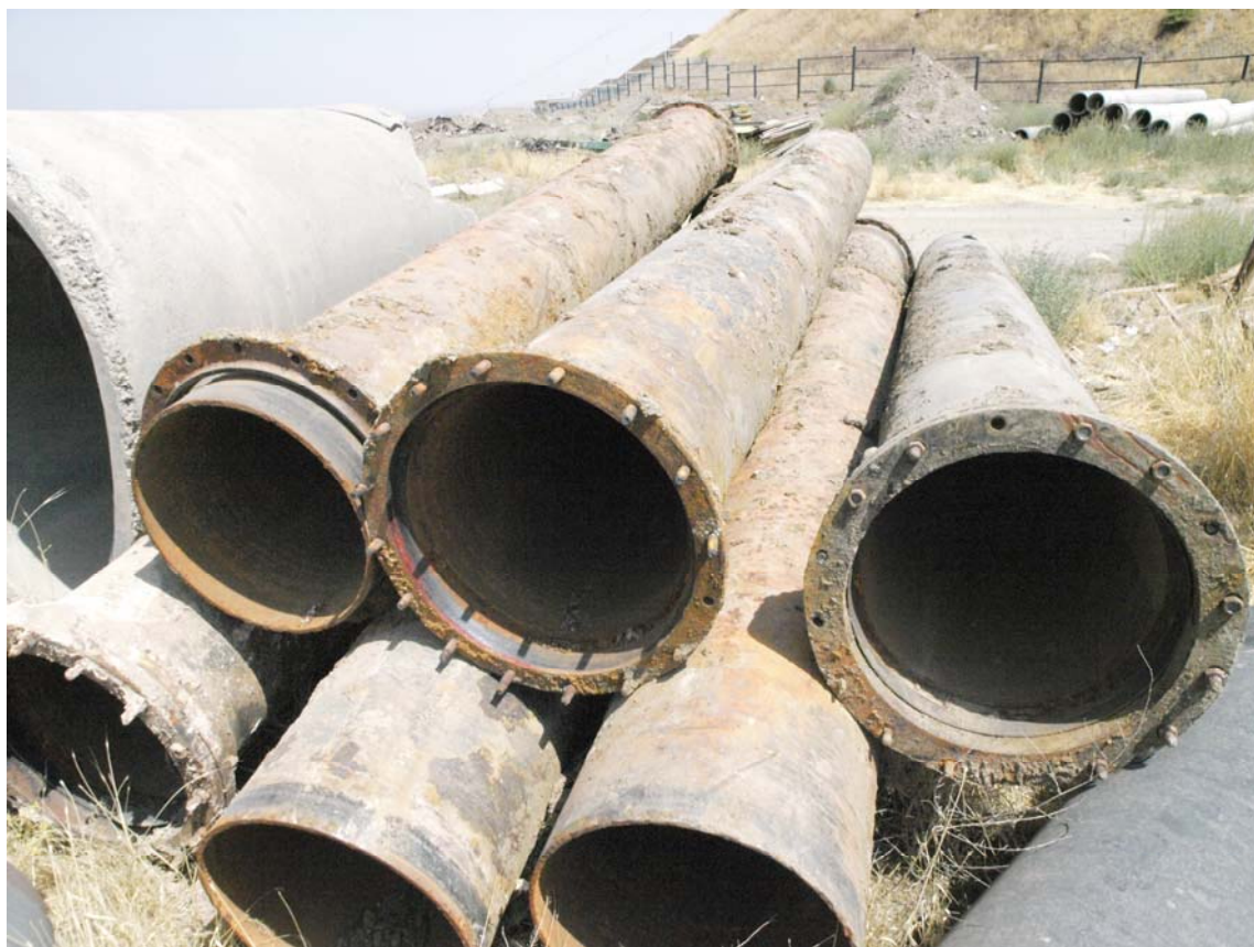
تصویر ۱-دپوی لوله‌های چدنی نشکن سایز ۵۰۰ میلی‌متر با قدمت ۳۵ سال، همدان ۱۳۹۰/۶/۵
