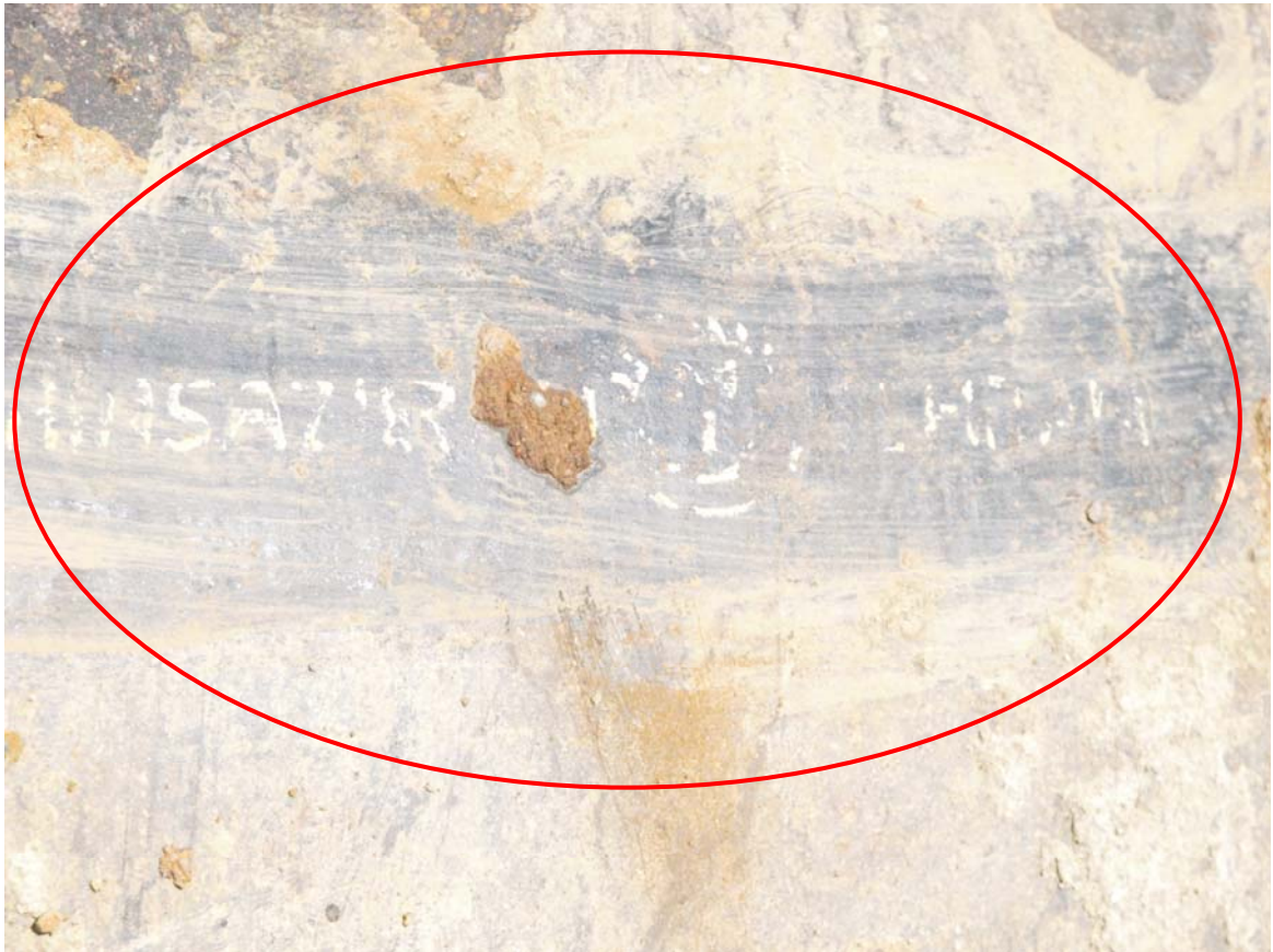
تصویر ۴- لوگوی شرکت لوله و ماشین سازی ایران بر جداره بیرونی لوله‌های چدنی نشکن با قدمت ۳۵ سال
