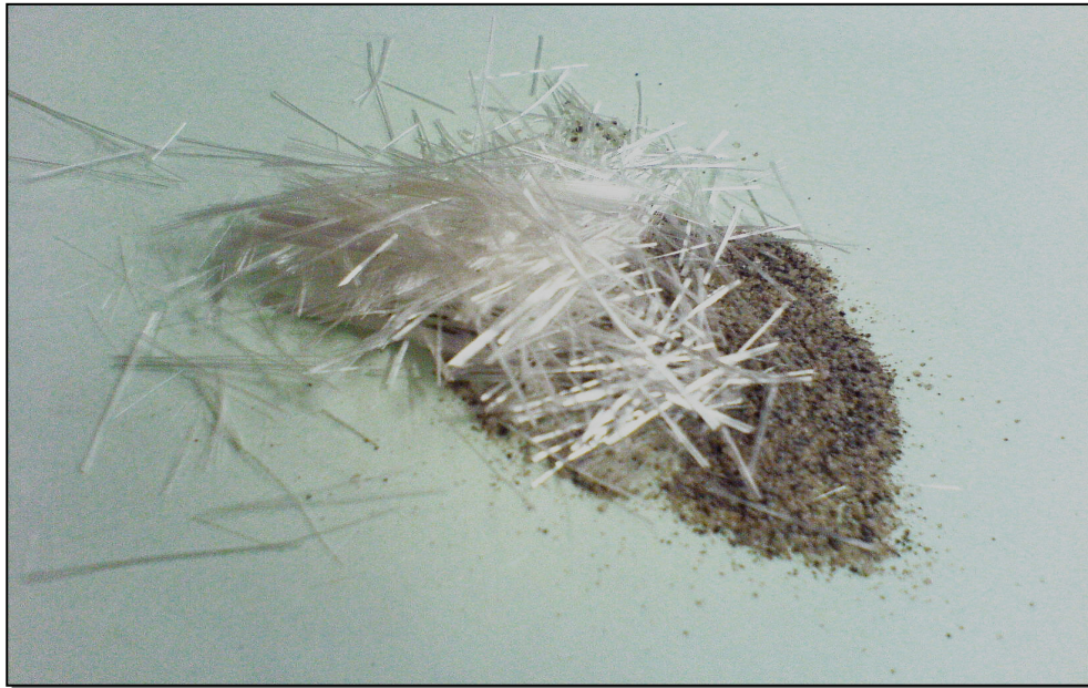
تصویر ۲. الیاف و ماسه باقی مانده از آزمایش تعیین ترکیب نمونه GRP
